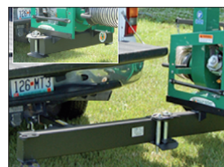
Výkynný závěs pro III. třídu, zajišťující na 90° a 180° pro snadné nakládání. Obj. č. SAH34
