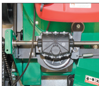
Samochodný pohon zadních kol (KV600SP a TKV650SPH) oceníte ve svažitém a nerovném terénu.
